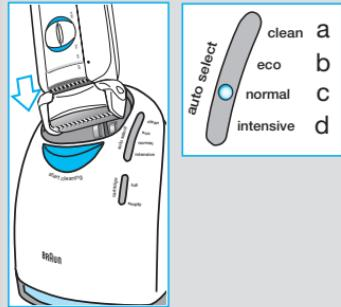
Si le système sélectionne l'un des trois programmes de nettoyage, il faut enfoncez le bouton « start cleaning » (début du nettoyage) (2) pour le faire fonctionner. Ce mécanisme fixe le rasoir au poste et active le processus de nettoyage.
